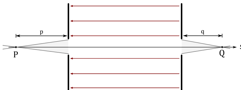
Abb. 2-12: Punkt-zu-Punkt Abbildung von P nach Q : jeder von P ausgehende Strahl wird im Punkt Q fokussiert.
